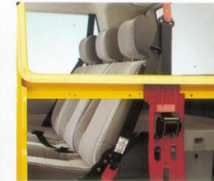
Verstärkung der Dachkonstruktion und der Sicherheitsgurtbefestigung am Beispiel der Caravelle-Baureihe.
