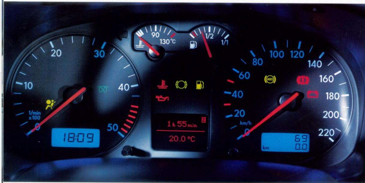
Kontrollleuchten für Airbag, ABS und ESP.
