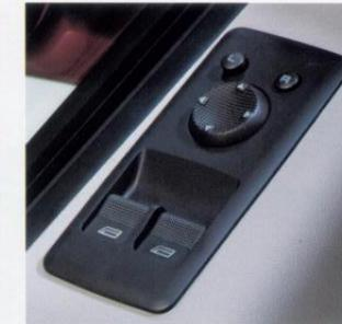
Bedienung für elektrische Fensterheber im Fahrerhaus und elektrische Außenspiegeleinstellung.
