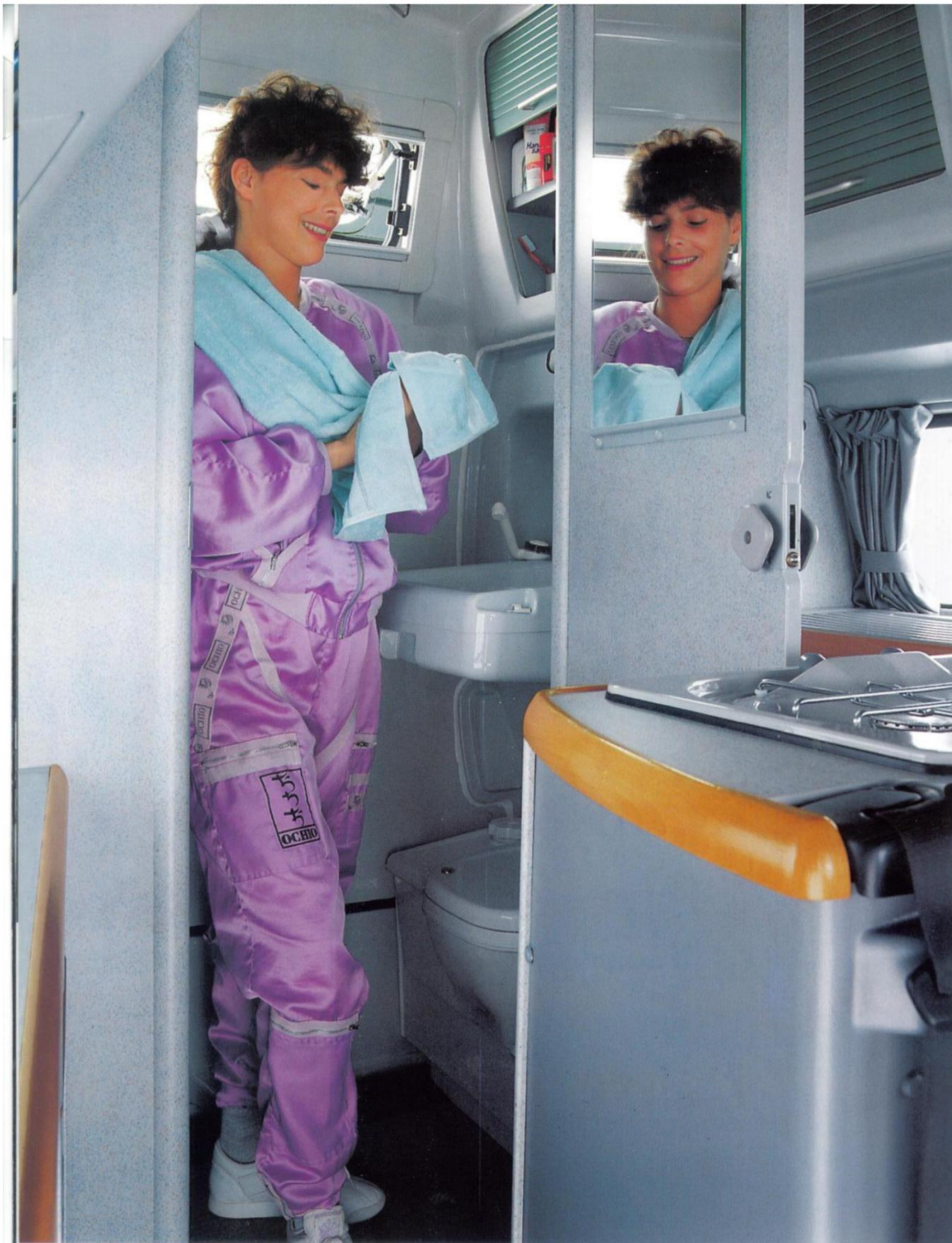
Abgeschlossener Sanitärraum mit Cassetten-Toilette und Klapp-Waschbecken.
